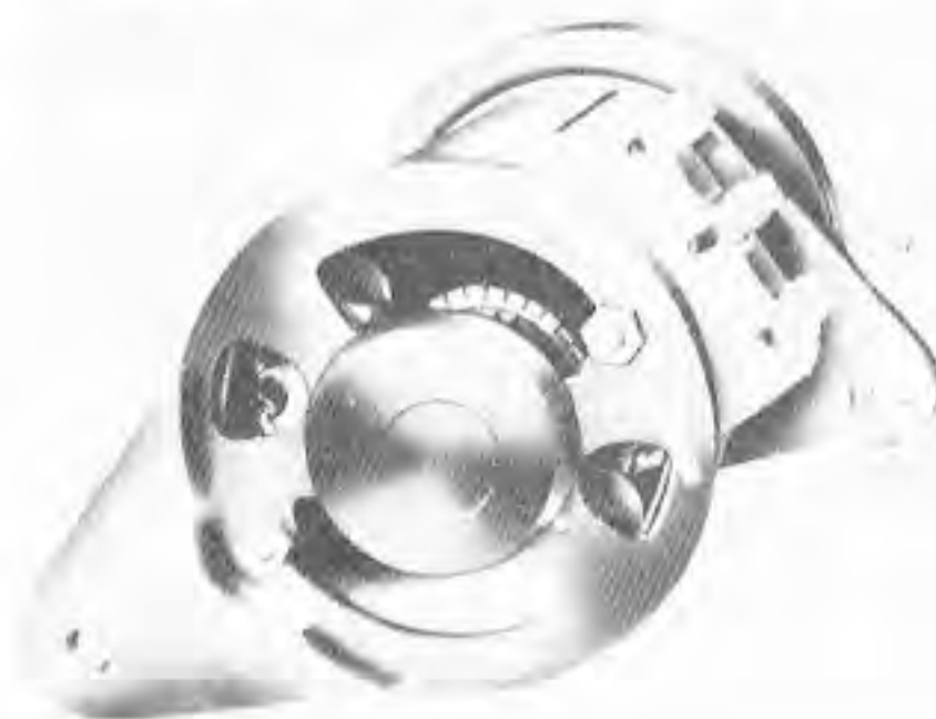
Obr. 187. Průchozí upevňovací šrouby vík dynama
