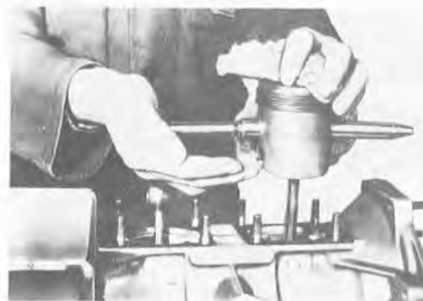
Obr. 78. Zasunutí pístního čepu do pístu
