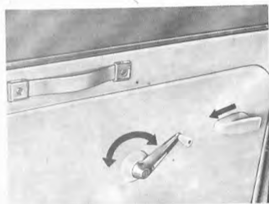
Obr. 9a. Zajištění zámku pravých dveří (do r. 1972)
