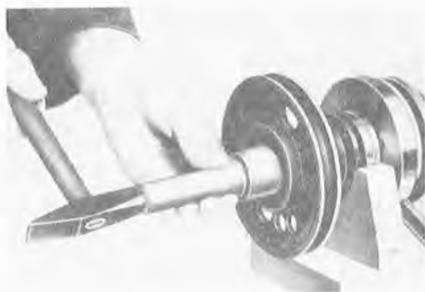
Obr. 74. Naražení řemenice na klikový hřídel
