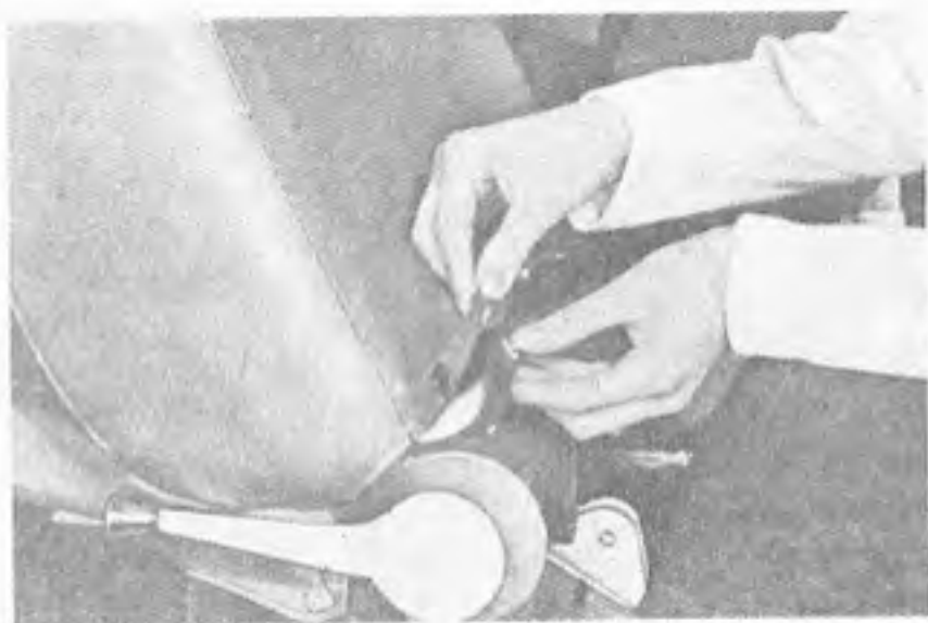
Obr. 30. Výměna potahu opěradla předního sedadla.
