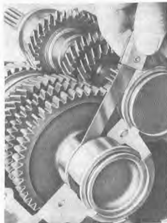
Obr. 113. Značky pro sestavení unášeče satelitů diferenciálu a talířového kola
