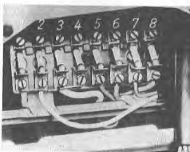
Obr. 212. Pojistky (zapojení do konce r. 1966) 1 — dálkové světlo levé, kontrolka dálkových světel; 2 — dálkové světlo pravé; 3 — tlumené světlo levé; 4 — tlumené světlo pravé; 5 — obrysová světla na levé straně; 6 — obrysová světla na pravé straně, osvětlení poznávací značky; 7 — blikače, stírač; 8 — brzdové světlo, houkačka, vnitřní osvětlení, zásuvka montážní svítilny, varovná světla
