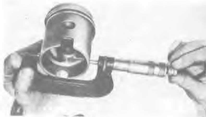
Obr. 67. Měření pístu mikrometrem
