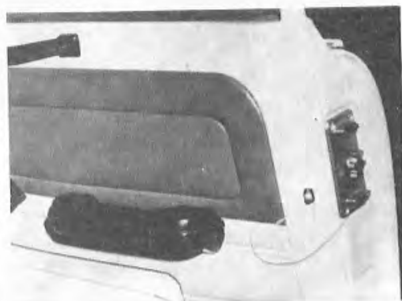
Obr. 9b. Zajištění zámku pravých dveří (od r. 1973)
