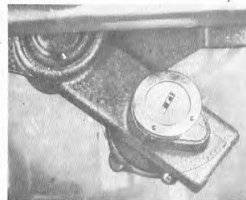
Obr. 17. Spínací skříňka zapalování kombinovaná se zámkem volantu P — zapnutá parkovací světla na levé straně vozu; 0 — vypnuto; I — zapnuté zapalování; 2 — spouštění motoru
