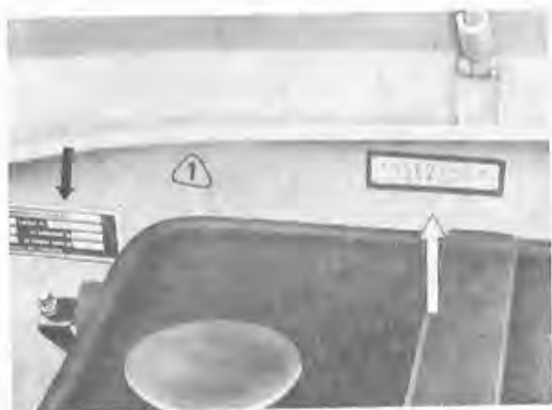
Obr. 6. Typový štítek vozu a výrobní číslo karosérie
