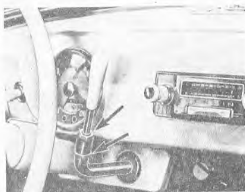
Obr. 235. Řadičí páka s kloubovým spínačem
