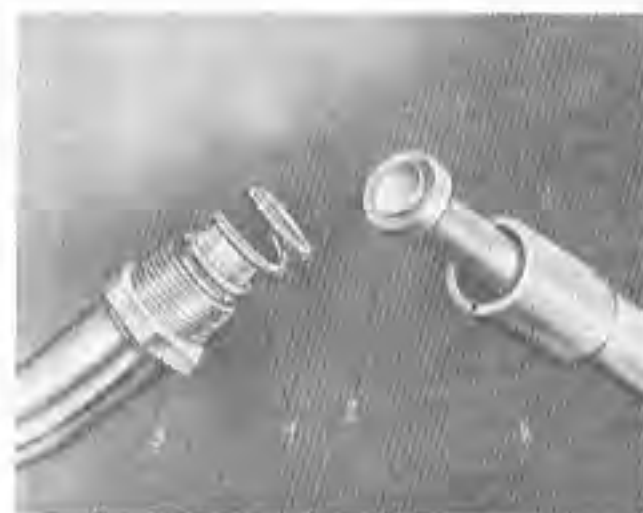
Obr. 240b. Kloubový spínač řadicí páky 1 – pevný kontakt; 2 – pohyblivý kontakt; 3 – přítužná matice; 4 – seřizovací převlečná matice
