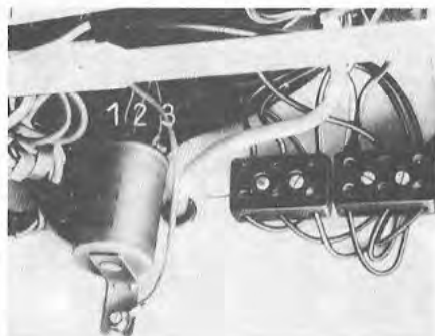
Obr. 210. Přerušovač blikačů 1 — svorka č. 49; 2 — svorka č. 49a; 3 — svorka c
