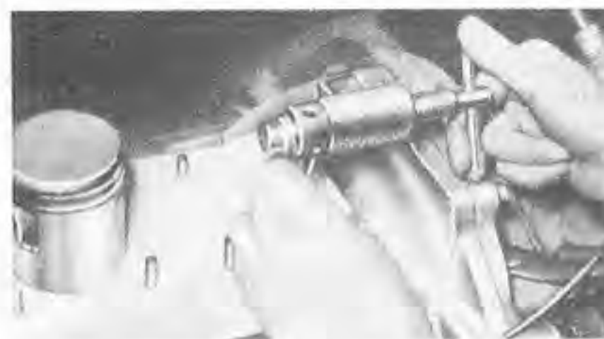
Obr. 69. Vytlačení pouzdra z oka ojnice
