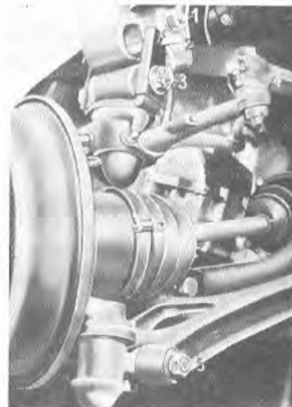
Obr. 132. Přední náprava (pohled zezadu) 1 — šroub teleskopického tlumiče; 2 — pojistná závlačka o \varnothing 8 mm; 3 — šroub pružného pouzdra pera; 4 — kloub spojovací tyče; 5 — pomocný čep vodícího ložiska dolního rejdového čepu a kyvného ramena
