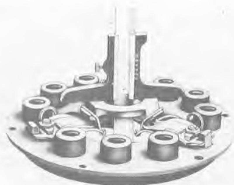
Obr. 91. Štít spojky s pákami a pružinami
