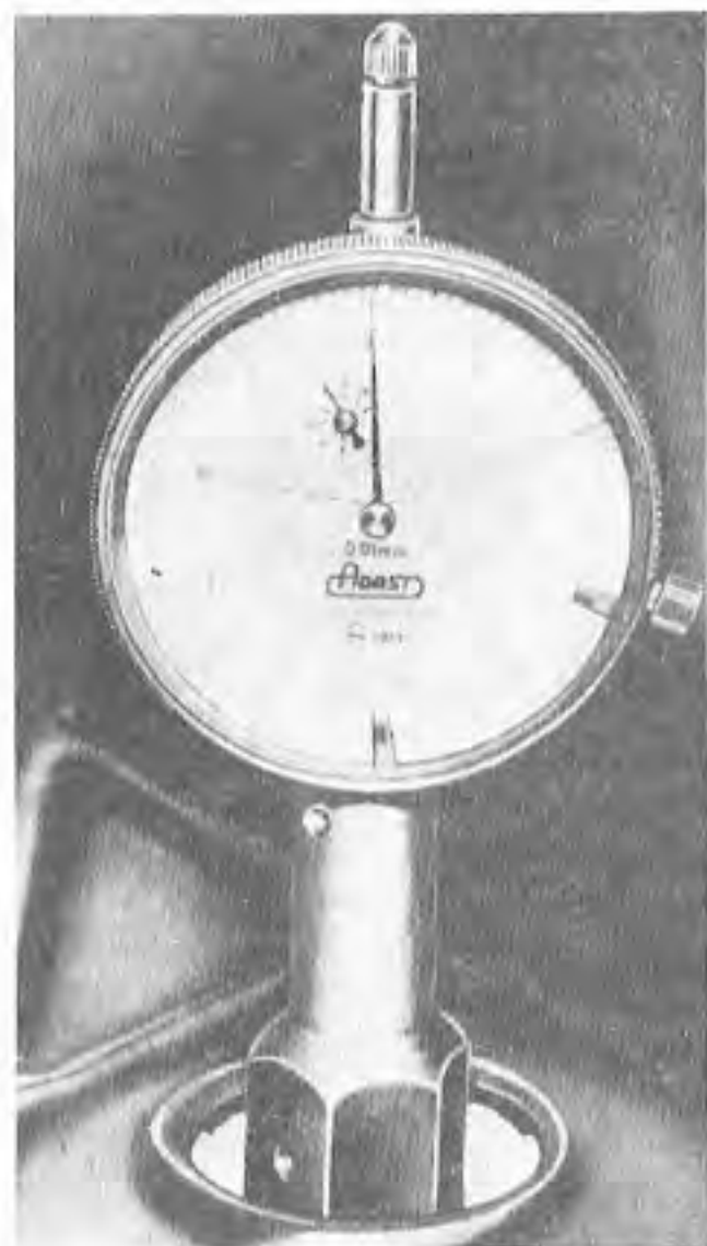
Obr. 182. Rozpínací přípravek pro nastavení předstihu
