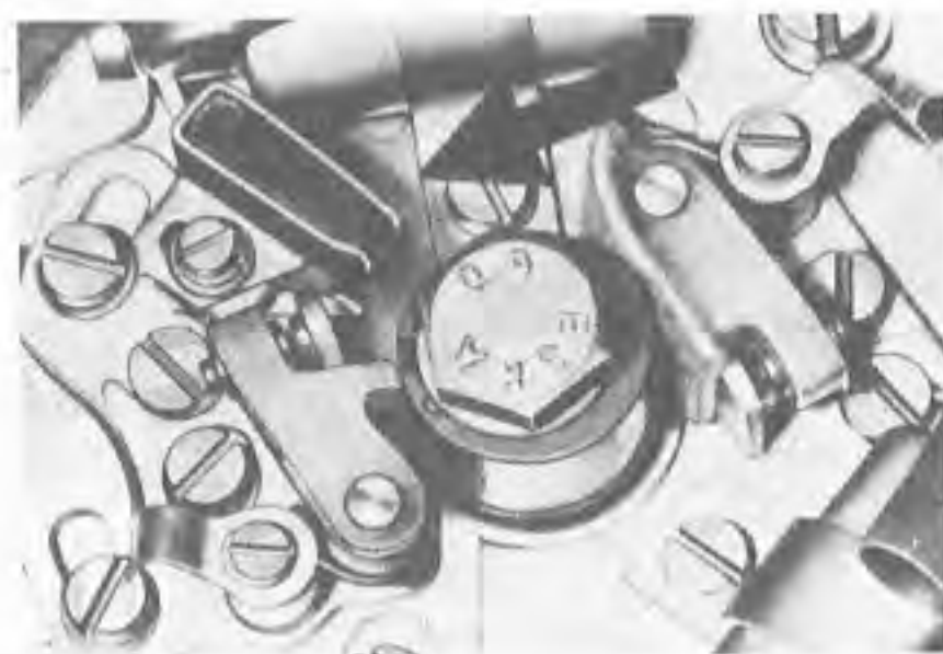
Obr. 179. Mazací plst vačky přerušovačů
