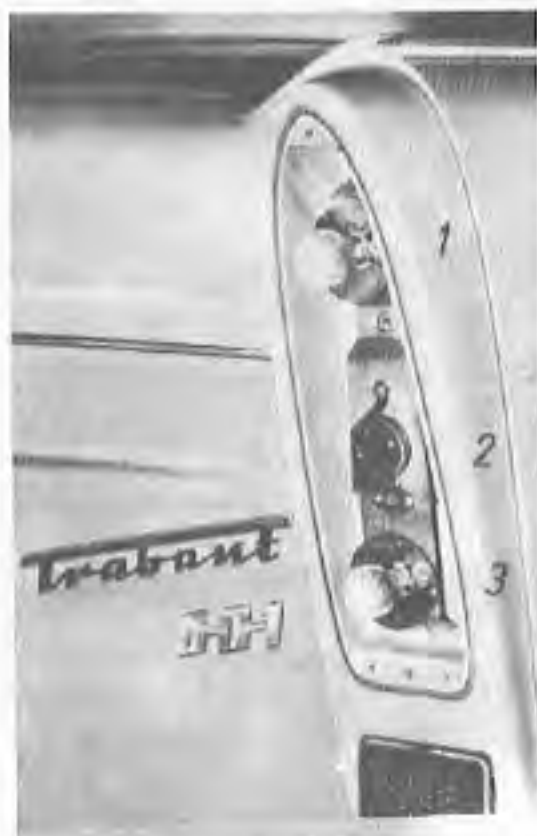
Obr. 202. Zadní skupinová svítidla 1 - blikač; 2 - obrysové světlo; 3 - brzdové světlo
