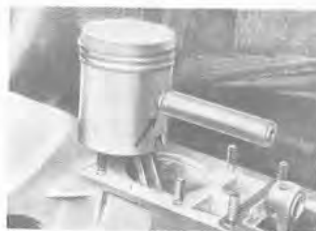
Obr. 79. Pístní čep zasunut do pístu
