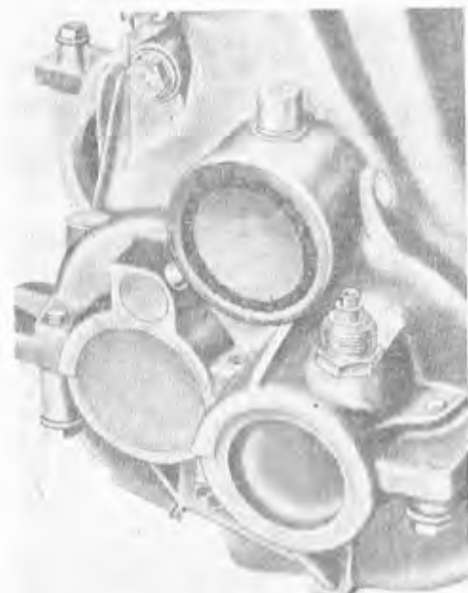
Obr. 114. Boční víka převodovky z levé strany 1 – zátka pojistky zpětného chodu; 2 – odvzdušnění převodovky; 3 – pohon rychloměru; 4 – kontrolní zátka hladiny oleje
