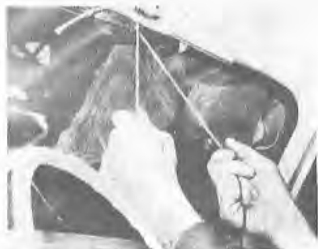
Obr. 226 Vtahování těsnění do okenního rámu
