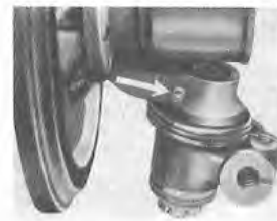
Obr. 138. Pojistný kolík dolního rejdového čepu
