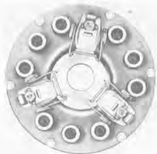
Obr. 91. Štít spojky s pákami a pružinami
