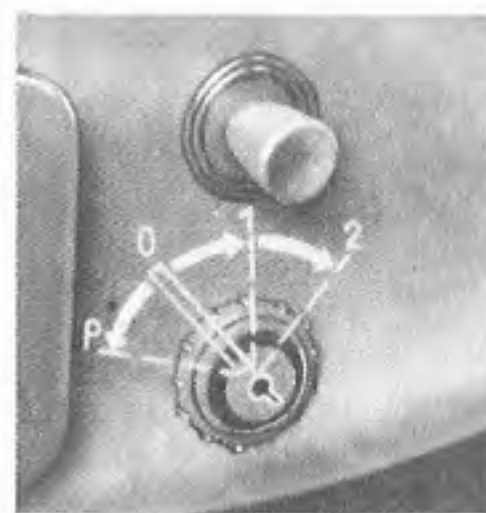
Obr. 16. Spínací skříňka zapalování P — zapnutá parkovací světla na levé straně vozu; 0 — vypnuto; I — zapnuté zapalování; 2 — spouštění motoru
