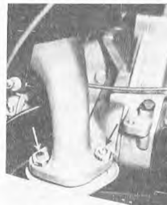
Obr. 45. Upevnění předřazeného tlumiče výfuku k hrdlu výfukového potrubí
