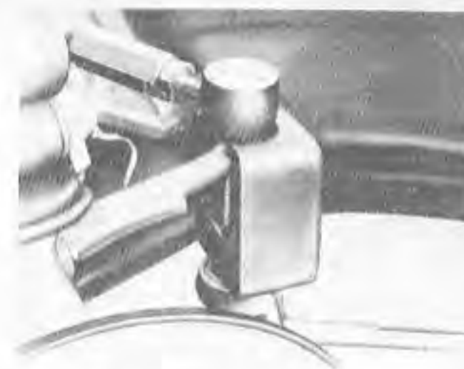
Obr. 123. Vytlačení kulového čepu z řídicí páky otočného závěsu
