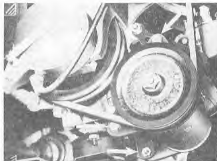
Obr. 188. Upevnění dynama na motoru
