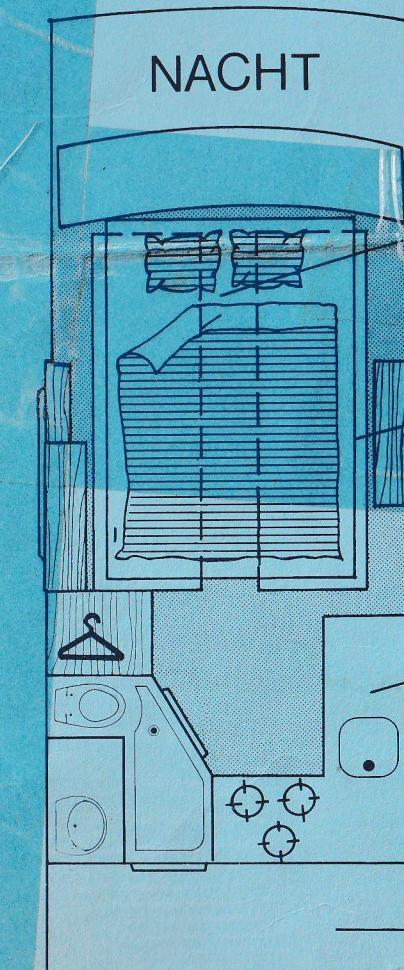
2 im abklappbaren Bug-Doppelbett 192 x 125 cm, (Patent T&B) Das Fahrzeug kann auch mit abgeklapptem Bugbett gefahren werden.
