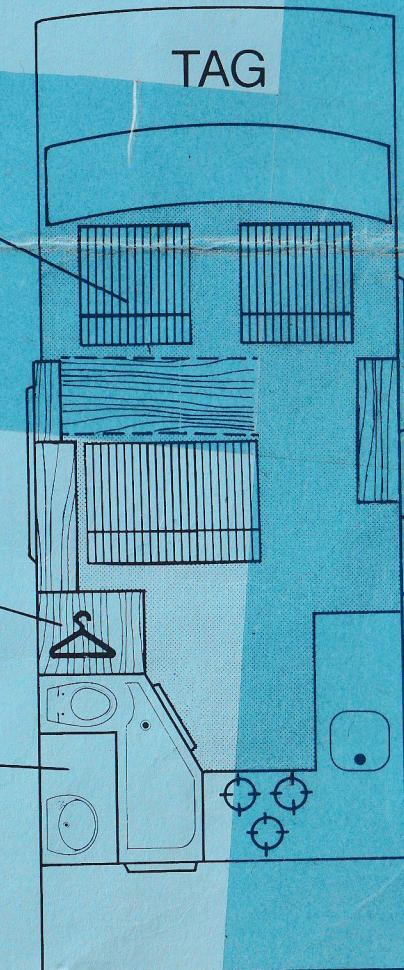
Toilettenraum in glasfaserverstärktem Kunststoff in einem Block gefertigt (75 x 90 cm) mit nautischem WC, Dusche, Lavabo
