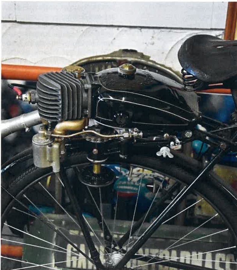
Detail přídatného spalovacího motoru „Moteurcycle L. Rosengart“ (1922) objemu 90 cm 3 (1,5 k), spotřeba 1,5 l/100 km, rychlost až 35 km/h. V roce 1924 kolo vyhrálo alpský závod z Aix-Les-Bains do Grenoble v délce 173 km, který urazilo za 7 hodin a 25 minut. Nad druhým mělo náskok hodinu a 24 minut...
