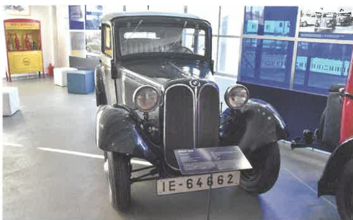
BMW 309 (1935) so štvorvalcom 845 cm 3 /22 k. Jazdil maximálnou rýchlosťou 85 km/h.
