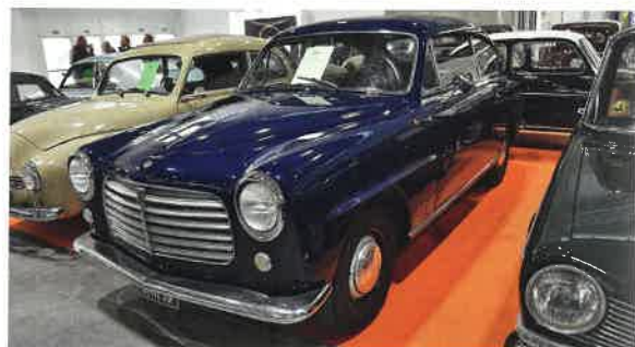
Na Turinském autosalonu 1950 Fiat představil typ 1400, který byl jeho prvním automobilem zkonstruovaným po druhé světové válce, a zároveň jeho prvním s celokovovou samonosnou karoserií
