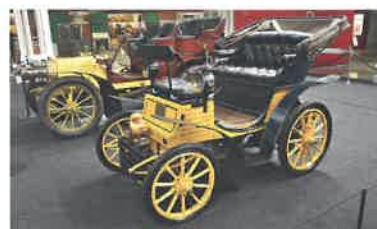
Nejstarší fiaty. Zleva 12/16 HP (1902) se čtyřválcem 3768 cm 3 (75 km/h) se vyznačoval prvním chladičem tvaru včelí plástve vyrobeným Fiatem. Vpravo první Fiat 3 1/2 HP 4,2 HP/800 min -1 , který opustil výrobní linku čerstvě založené společnosti v roce 1899
