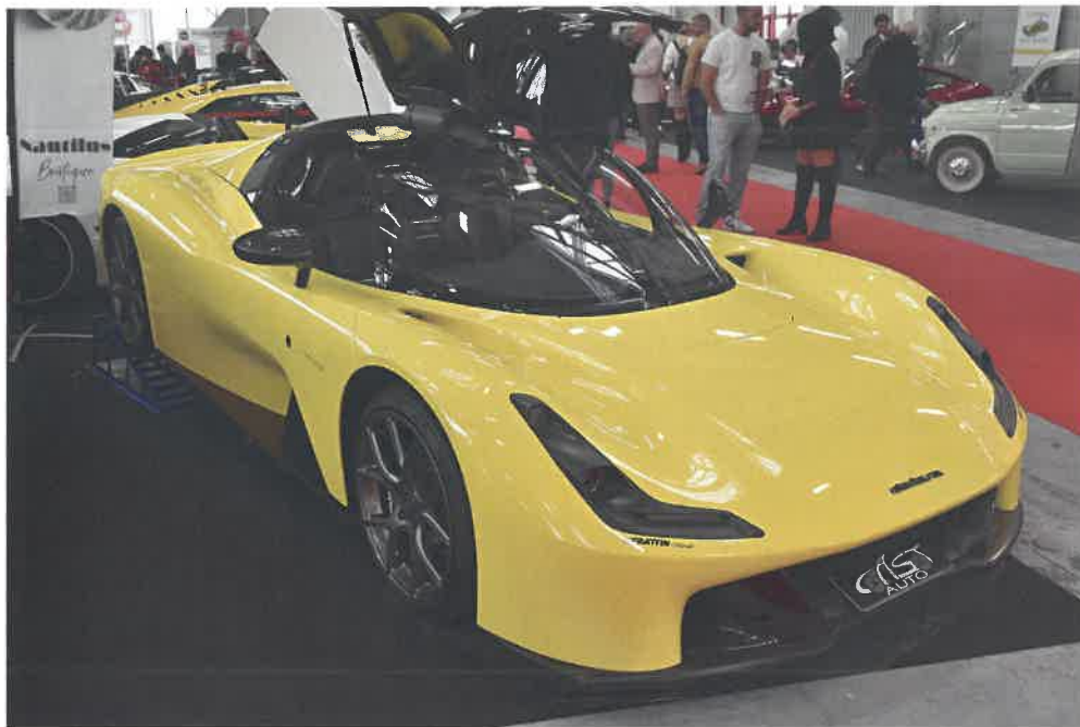
Dallara Stradale se vyskytovala na několika stáncích ve všech karosářských provedeních – berlinetta, roadster, targa i barchetta. Začali ji vyrábět v roce 2017. Zadní kola pohání 2,3litrový, uprostřed napříč uložený motor Ford EcoBoost (jako má Ford Focus RS; až 400 k). Šestistupňová převodovka může být řazená ručně nebo samočinně
