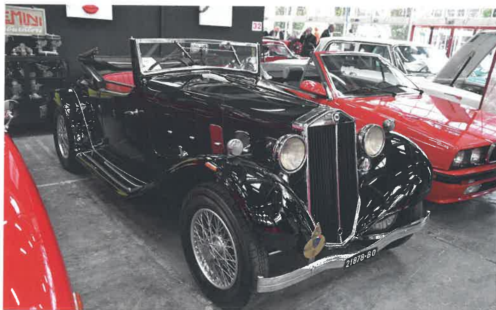
Unikátní Lancia Augusta Spider Borghi (1936), jediný dvoumístný vůz postavený na šasi Augusty. Objednal si jej markýz Ferrerti, který s ním často závodil. Boloňský karosář Borghi zkrátil šasi, dozadu umístil velkou palivovou nádrž (benzínové pumpy se vyskytovaly zřídka), čtyřválec 1196 cm 3 (35,4 k) ladil uznávaný Sartori Tano. V závodech porážel fiaty s motory 1,5 litru
