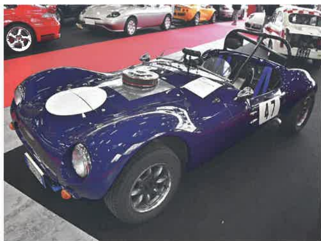
Dallara Stradale se vyskytovala na několika stáncích ve všech karosářských provedeních – berlinetta, roadster, targa i barchetta. Začali ji vyrábět v roce 2017. Zadní kola pohání 2,3litrový, uprostřed napříč uložený motor Ford EcoBoost (jako má Ford Focus RS; až 400 k). Šestistupňová převodovka může být řazená ručně nebo samočinně
