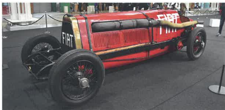
Fiat Mefistofele (1923) s řadovým šestiválcovým leteckým motorem A12 21 706 cm 3 (320 k/1800 min -1 ) zabudovaným v prodlouženém podvozku SB4, řízený Ernestem Eldridgem, dosáhl na přímé silnici u Arpajonu rychlostního rekordu 234,980 km/h
