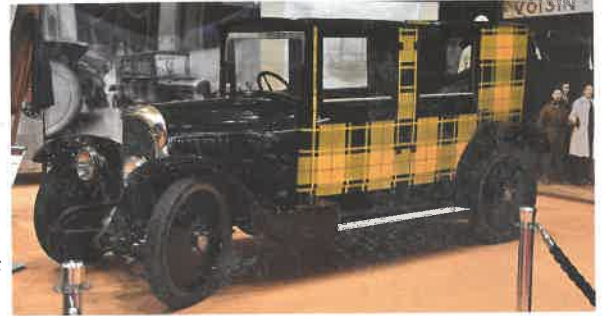
Voisin C4s Berline (1924) se čtyřválcem 1250 cm 3 (30 k) ozdobený skotským vzorem
